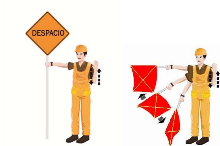
Para alertar o desacelerar el tránsito
